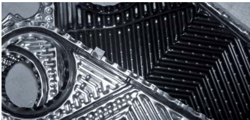
Centrum zmiany temperatury: Im czystsze są lamele, przestrzeń między nimi i wgłębienia wymiennika, tym lepsza cyrkulacja medium przewodzącego ciepło.
